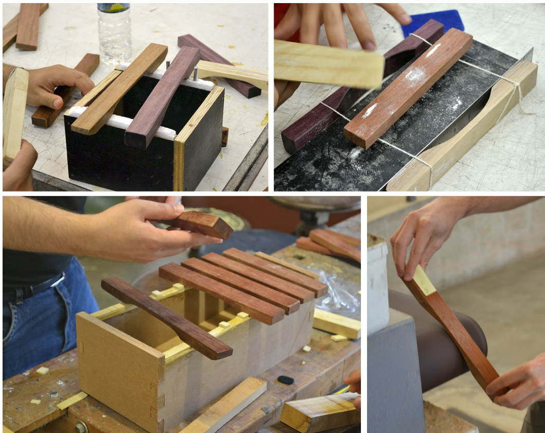
Figura 7. A construção de um xilofone foi motivação suficiente para, no contexto do exercício proposto, mobilizar investigações empíricas extensas e refinadas, apoiadas no trabalho direto com a matéria.
